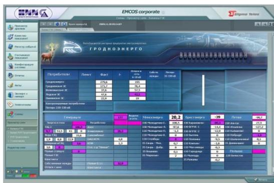
*Варианты различных информационных окон системы в т.ч. диспетчерской подсистемы созданные встроенным редактором мнемосхем.*
